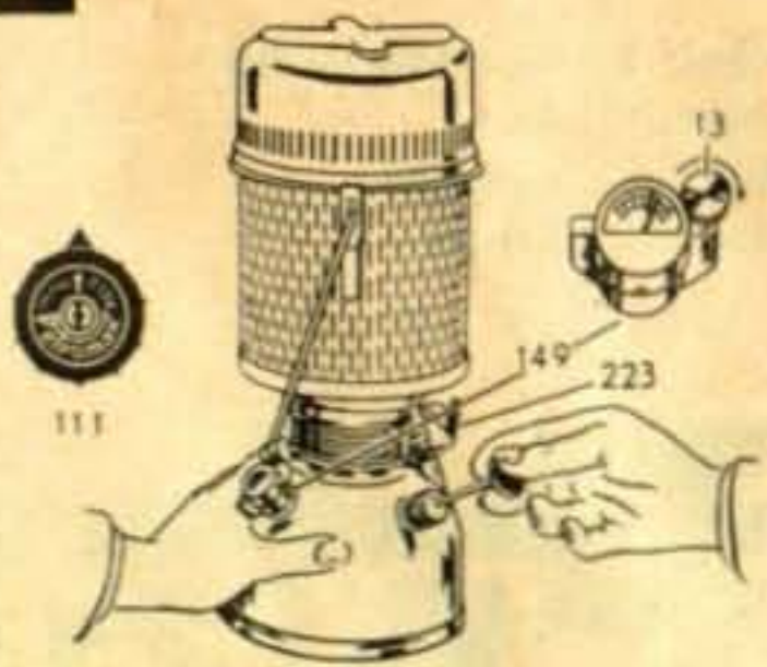
Bild 2 Luft in den Behälter pumpen
